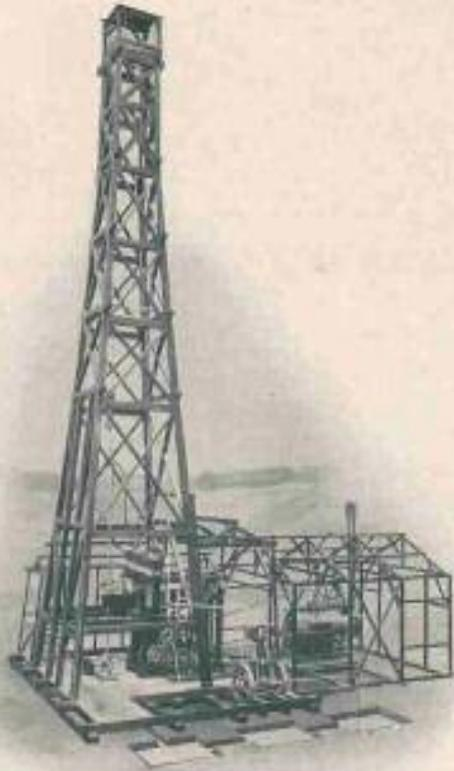
Fig. 1. Treuil de Forage à battage rapide disposé sous une tour en bois.
