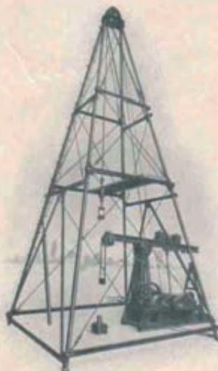
Fig. 2. Treuil de Forage à chute libre disposé
