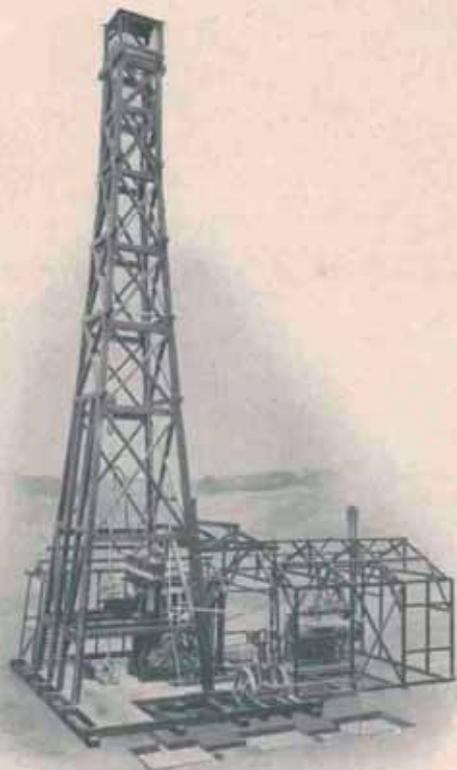
Fig. 1. Treuil de Forage à battage rapide disposé sous une tour en bois.
